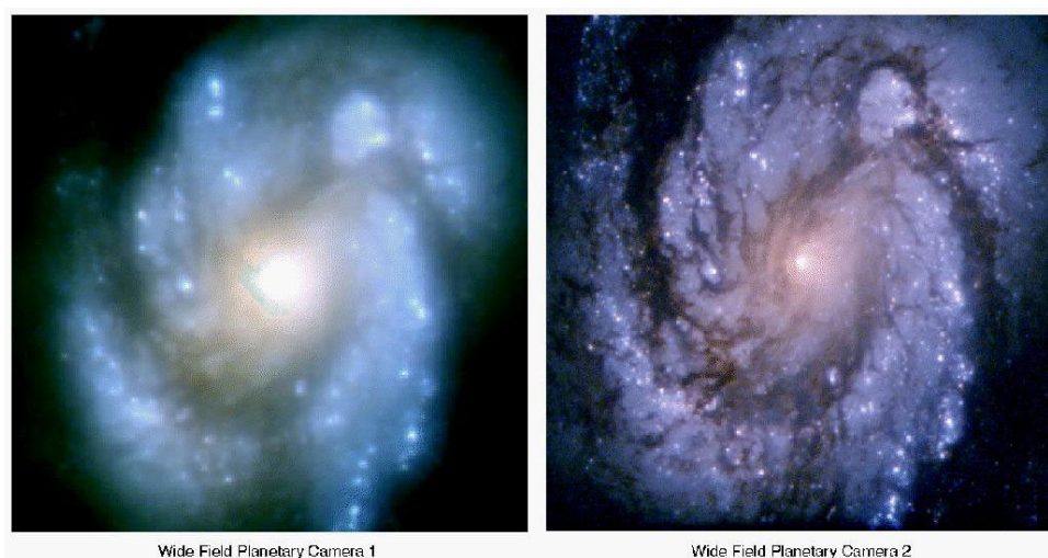
图 1 星系 M100 的核心区域。左：校正前用第一代广角行星相机（WFPC1）拍摄，主镜球差使星像弥散；右：第一次维修任务装上自带校正光学的 WFPC2 之后拍摄。（图源：NASA, STScI, 新闻稿 STScI-PRC1994-01 (1994-01-13)；按 STScI 版权说明（ www.stsci.edu/copyright ）属公有领域） [5]
